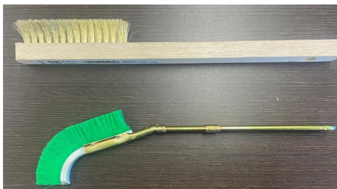
写真3 ブラシ例 上：ワイヤーブラシ（真鍮製） 下：ナイロンブラシ（毛が固く、密度が高いもの）
