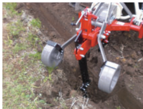
写真4 サブソイラーの水尻(排水口) への連結
