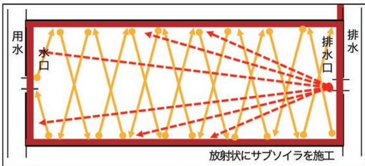
図1 放射状+短辺対角線状の暗渠施工
