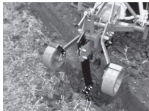
写真4 サブソイラーの水尻(排水口)への連結
