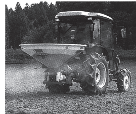
ブロードキャストによる土壤改良資材の散布
