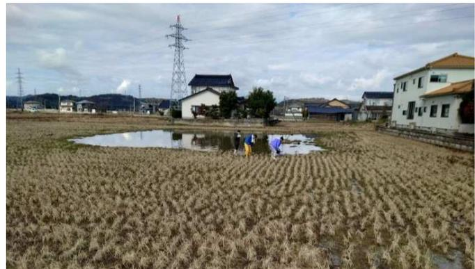
写真2 噴砂により発生した水たまり
